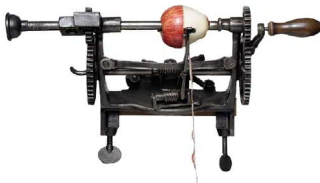
Apfelschälmaschine, Patent E. Herzog, Unicum Nr. 6. Gusseisen, Graz um 1890. Foto: N. Lackner
