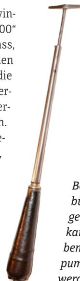
*Bevor diese Windbüchse in Betrieb genommen werden kann, muss ihr Kolben mit einer Luftpumpe aufgepumpt werden.*
