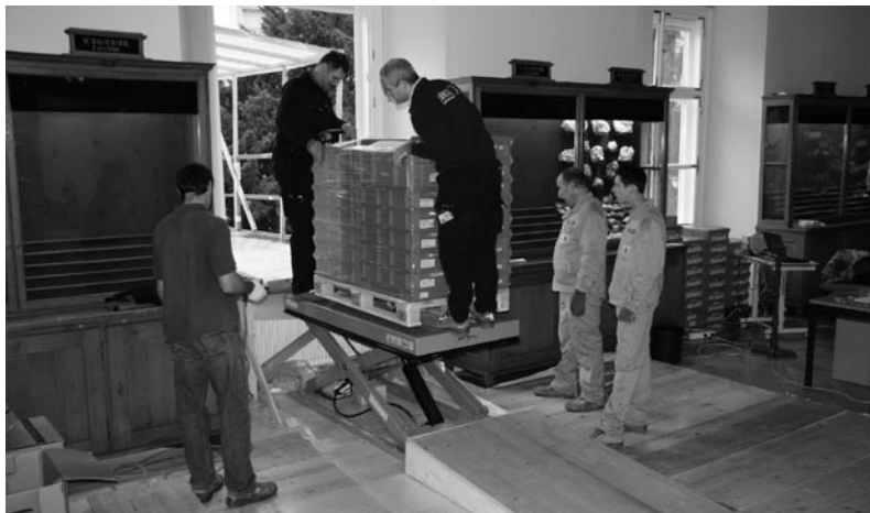
Die fertig verpackten Transportkisten werden über einen Hubtisch durch ein erweitertes Fenster des Stucksaaes auf den Scherenhublift verladen. Foto: UMJ, H.-P. Bojar
